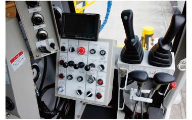
施工管理装置は施工時のデータをタッチパネルモニタに表示し、確実な施工をサポートします。施工データはタブレット端末に保存され、USBメモリを使用し、施工データの移行が可能です。施工データ処理ソフトにより柱状改良・鋼管杭打設の施工データを容易にグラフ化・表処理を行えます。付属のプリンターでリアルタイムに印刷可能です。施工支援システムはオペレータに現場で必要な情報を提供し、高精度な施工を支援します。
