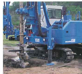
φ1,000mm柱状改良用攪拌ビット
