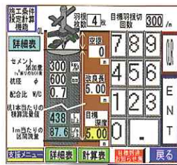
柱状改良 施工支援画面
